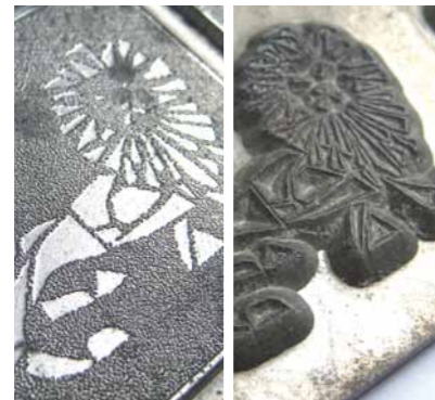
Magnesium Prägewerkzeug Struktur und Plan
