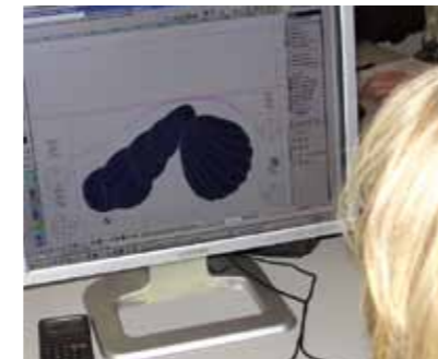
Umsetzung der Vectordaten in CNC-Fräsdaten für Prägewerkzeuge
