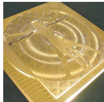
Prägewerkzeug mit unterschiedlichen Microembossing-Strukturen
