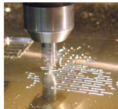
CNC-Gravur der Messingplatte
