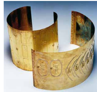
Prägewerkzeug mit unterschiedlichen Microembossing-Strukturen
